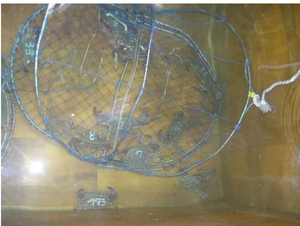
試作カゴによるガザミ脱出試験の様子
