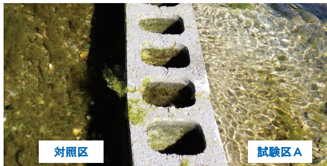
図4 コンクリートブロック敷設後21日目 (対照区に繁茂した珪藻等の夾雑物)
