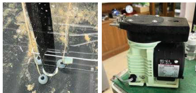
図2 エアストーン配置とエアポンプ
