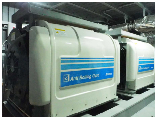
写真 5 船体横揺れ減揺機 (ARG)
