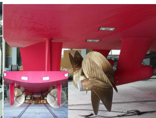
写真 6 LC 型 5 翼固定ピッチプロペラ
