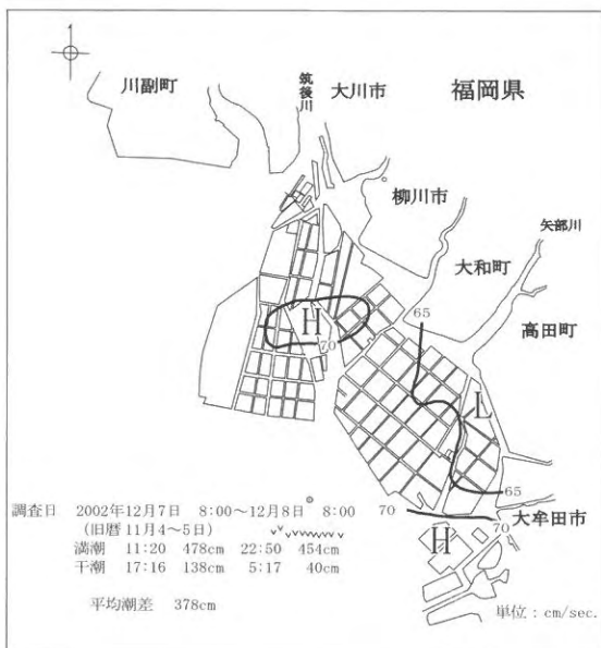
図1 ノリ網の一斉撤去中における24時間平均流速の分布 全平均: 67.9cm/sec.
