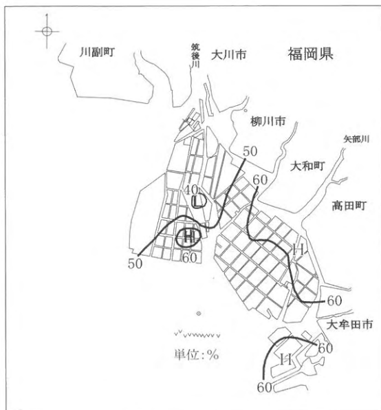
図3 ノリ網張り込みによる平均流速減衰率の分布 \text{流速減衰率} = (\text{一斉撤去中流速} - \text{冷凍生産期流速}) / \text{一斉撤去中流速} \times 100
