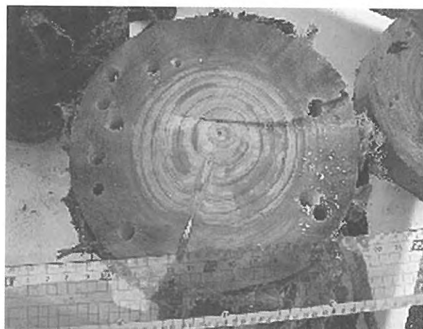
図5 テストピース(ひのき)のフナクイムシ棲管
