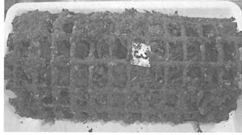
写真4-2 FRP炭化材-粗
