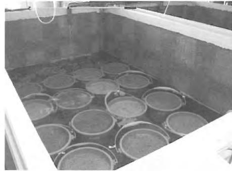
図1 固結状況試験写真
