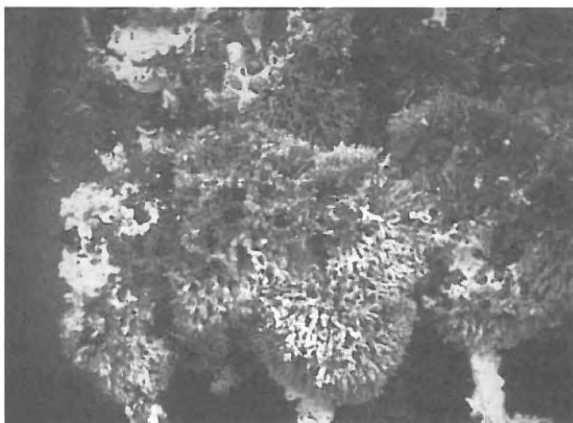
図3 試験礁No 1のテストピース (RPP炭化材-密)の付着生物の状況
