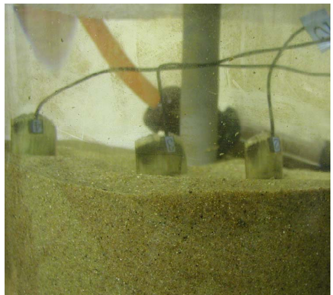
図21 開閉センサーの設置状況
