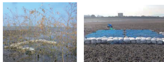
図1 干潟面に設置した各試験区の写真(上部右;砕石枠区, 上部左;竹杭区, 下部左;笹竹区, 下部右;被覆網区)
