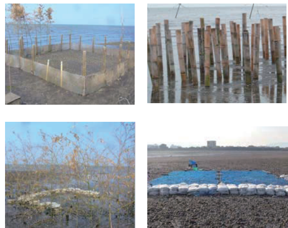
図1 干潟面に設置した各試験区の写真(上部右;砕石枠区, 上部左;竹杭区, 下部左;笹竹区, 下部右;被覆網区)
