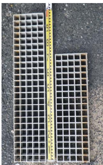
図1 FRP製グレーチングと設置した様子（試験区B）
