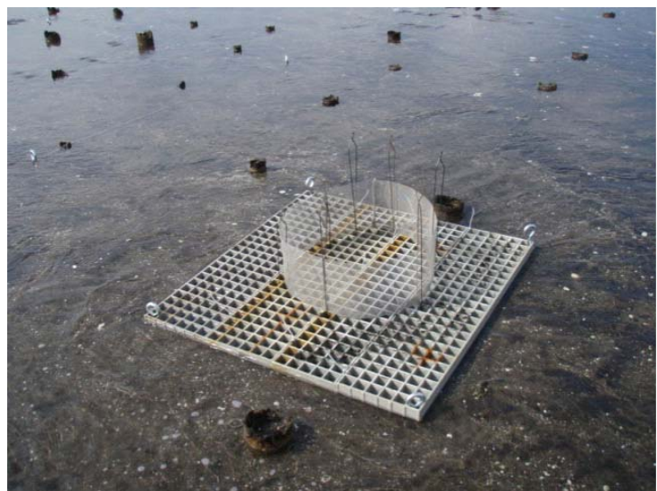
図1 FRP製グレーチングと設置した様子（試験区B）
