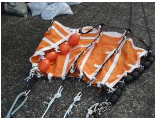
図1 小型底びき網用柔構造拡網装置
