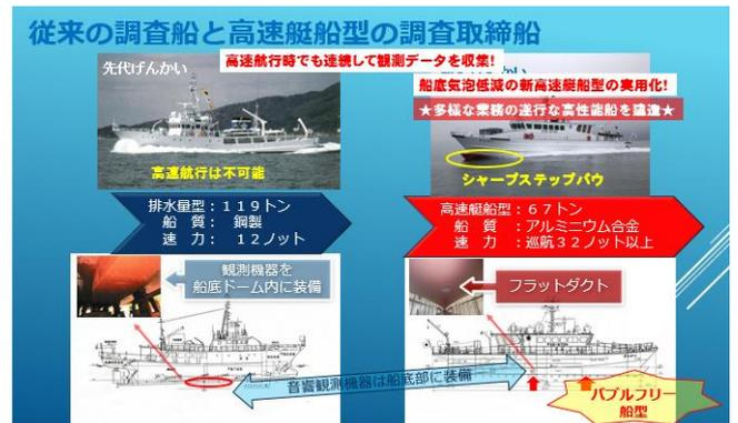
従来の調査船の多くは高速航行が不可能な排水量型であり、船底部に装備する音響観測機器は船底ドーム内に装備することで観測機器の性能を確保しています。しかしながら、近年の世代的な能率向上と多様化の要求により、高速航行時でも連続して観測データの収集が可能な調査船の実現が望まれてきました。
