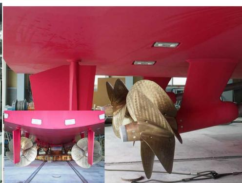
写真 6 LC 型 5 翼固定ピッチプロペラ
