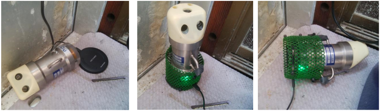
図4 S-CTDを充電補助器具に取り付けた状況や転倒した状況
