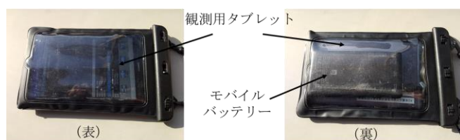
図 3 漁業者による省電力機能 (Doze モード) 対策方法
