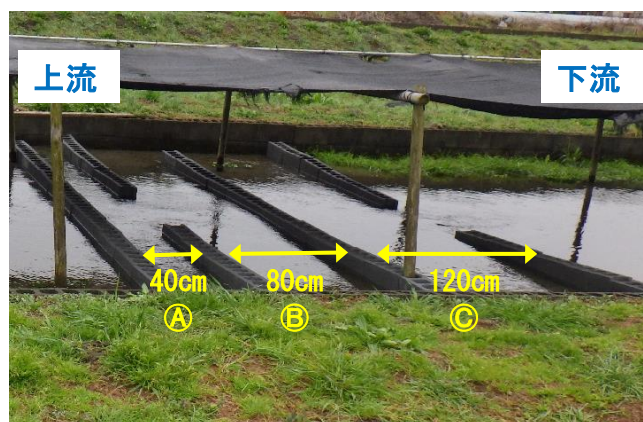
図1 コンクリートブロックを敷設した試験区
