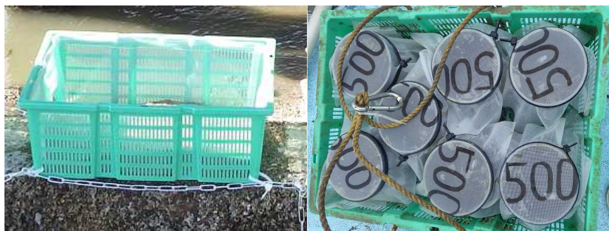
図2 装置の構造（左：有明式装置，右：豊前式装置）
