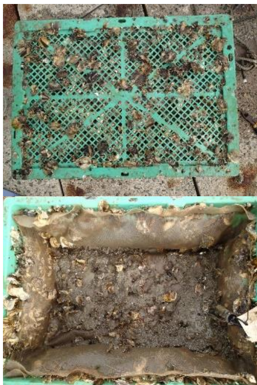
図 16 漁港に設置した装置の付着物の状況
