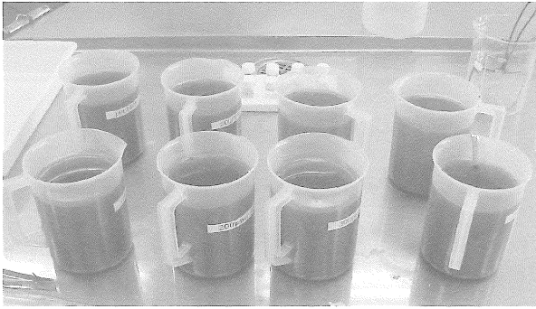
図6 アリザリンレッドSによる染色試験
