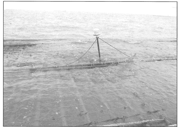
図5 低浮力状態の試験筏（空気注入前）
