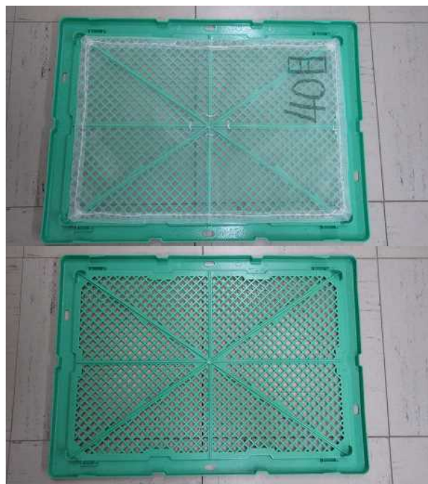
図4 有明式装置の蓋の構造 (上：蓋メッシュ有区 (目合526 \mu m), 下：蓋メッシュ無区 (目合7.8mm))
