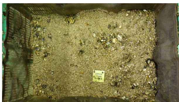
図15 試験終了時の付着生物の状況 (カキ類の付着が最も多かった試験区：夏季試験)
