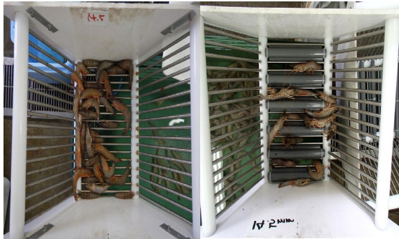
図 選別の状況（左：改良前 右：改良後） ※改良前はエビが横になり、スリットを抜けていない
