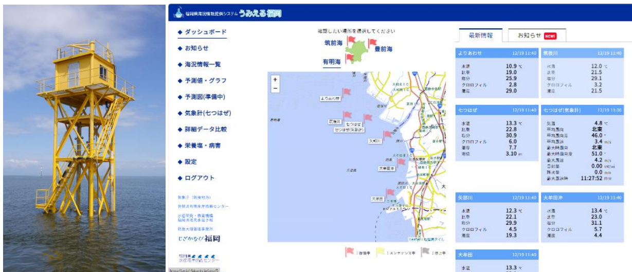
図3 漁場に設置した観測塔（左）及びセンサー設置位置と観測結果の画面（右）
